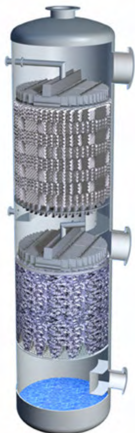
Внутренние устройства колонн
